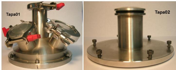
Figura 5.13 Tapas de la cámara de descarga utilizadas en el estudio. Conexiones de vacío en ambas tapas tienen la misma norma. *tapa01* fue utilizada en el estudio de optimización.
